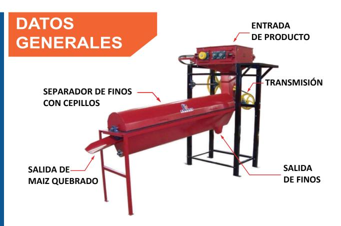
El quebrador cuenta con una joroba magnética con un imán de retención de metales, así como dos compuertas de guillotinas, una de tornillo para controlar la alimentación de maíz al quebrador y otra de cierre rápido. En la parte interna del quebrador, tiene una tolva que contiene al maíz evitando que se salga el maíz sin quebrar, esto se logra con unos sellos de UHMW de 3/8", los cuales se pueden ajustar conforme se desgasten los rodillos.
